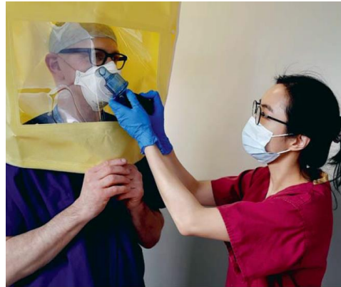
Abbildung: Ärztlicher Mitarbeiter bei einer qualitativen Dichtsitzprüfung während der COVID-19-Pandemie: Mithilfe eines Verneblers wird durch die vordere Öffnung ein bitterer Prüfstoff in die Haube gesprüht. Schmeckt die zu prüfende Person während der sieben verschiedenen Übungen die vernebelte Lösung nicht, wird ein akzeptabler Dichtsitz festgestellt und der Test ist bestanden. Dieser Test ist für Einmalmasken sowie für wiederverwendbare Halbmasken vorgesehen.
